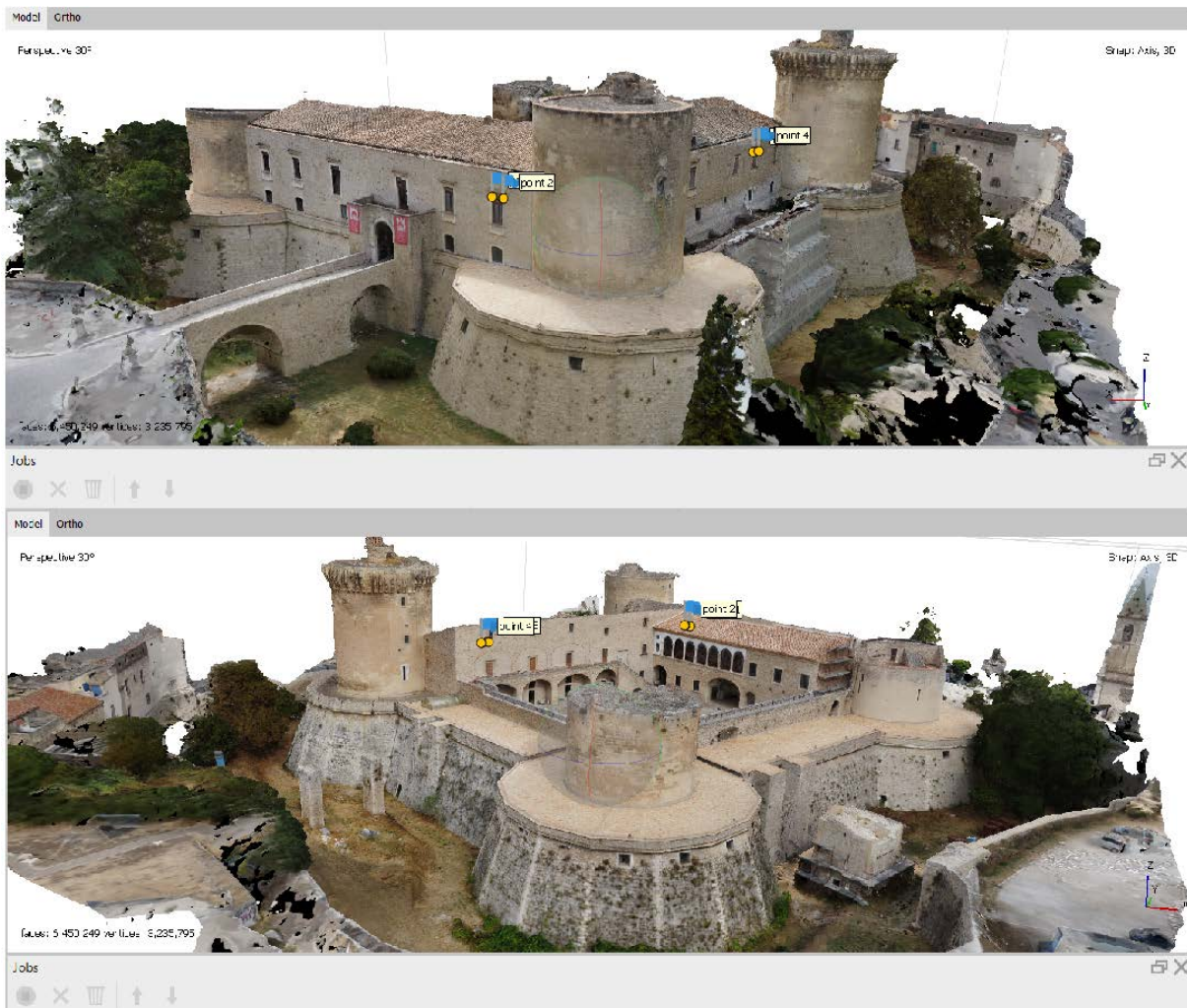
Fig. 3 – Elaborazione del modello di rilievo fotogrammetrico del castello di Venosa
