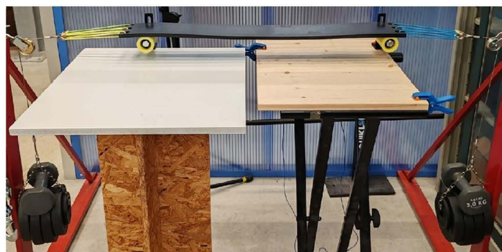
Fig. 2 – Setup sperimentale della trave in gomma NBR.
