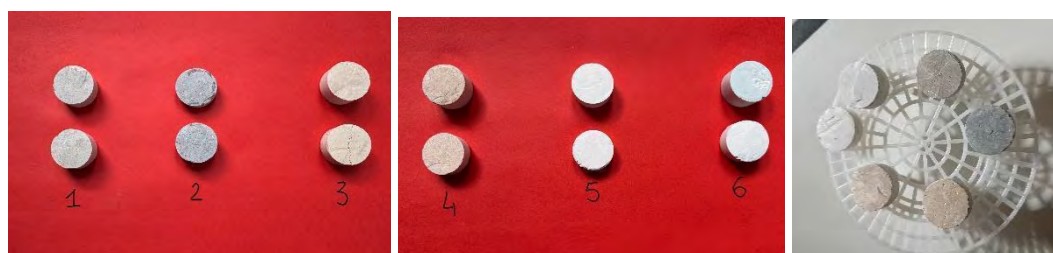
Figura 1. Paste di cemento a base di \text{MgO} (MbriC) stagionate in aria (sx) e in atmosfera al 10% di \text{CO}_2
