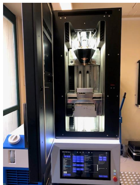
Sistema per additive manufacturing per la lavorazione di materiali metallici
